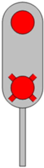
Rys. 205. Sygnał S 1a
