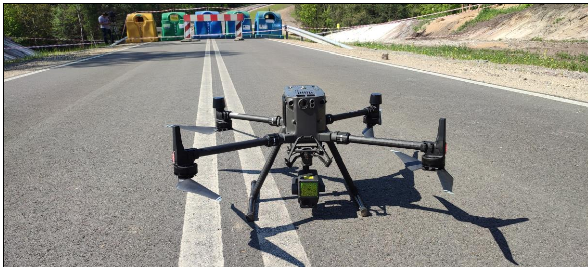
Rys. 6. BSP z zamontowanym skanerem laserowym DJI L1
