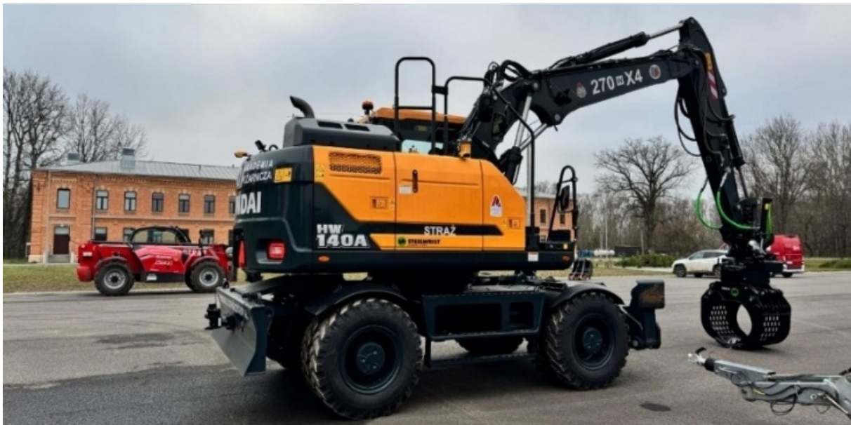
Zdjęcie 2. Samobieżna wielofunkcyjna maszyna inżynierska
