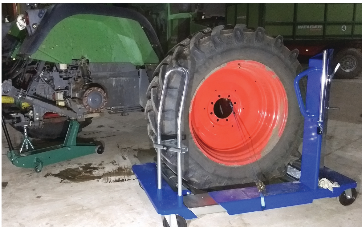
Zestaw urządzeń i narzędzi do zmiany kół ciągnikowych, ułatwiający bezpieczną pracę
